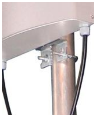
Пример крепежа панельной UHF антенны
