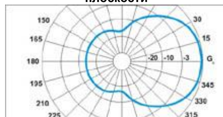
Диаграмма направленности антенны Y5 AVIA в H-плоскости
