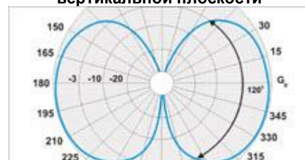
Диаграмма направленности антенны SS-1CDMA в вертикальной плоскости
