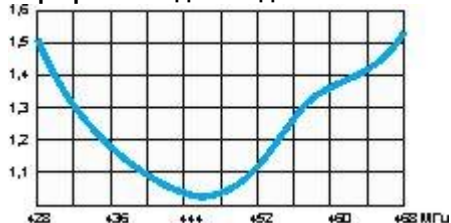
График КСВ для модели АЗ-70 см
